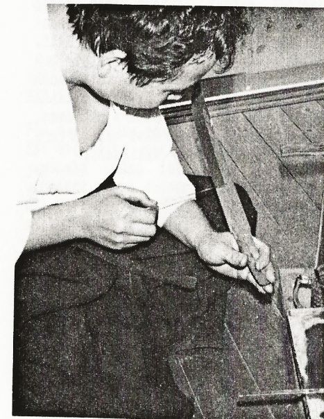
Svärdsmeden Yoshindo Yoshiwara gör mönster i leran. Detta för att ge hårdningslinjen det önskade utseendet.
