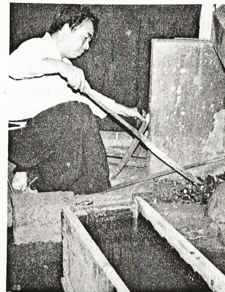
Smeden hettar upp klingan till en viss temperatur, innan härningen sker.
